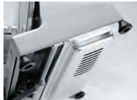
Luchtgekoelde motor beschermd door metalen afdekkap
